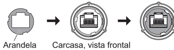
6. Conecte el conector impermeable ensamblado al cable LAN de la antena.
