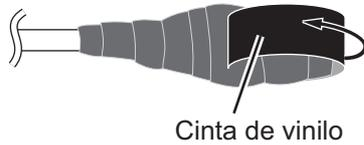
4) Envuelva el conector con una capa de cinta de vinilo. Sujete el extremo de la cinta con una brida de cable para evitar que la cinta se desprenda.
