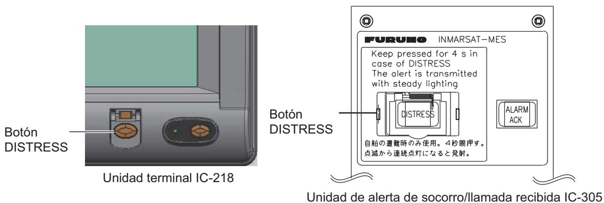
2. Pulse el botón **DISTRESS** (durante cuatro segundos aprox.) hasta que la luz del botón se ilumine de forma continua. La alerta de socorro no se enviará hasta que la luz del botón se ilumine de forma continua y la alarma acústica suene. Mientras se envía la alerta de socorro aparece en la pantalla el mensaje "Sending Distress Alert" (caracteres en blanco sobre fondo rojo).
