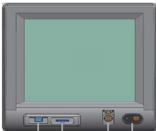
Ranura para tarjeta SD      Interruptor de encendido POWER
