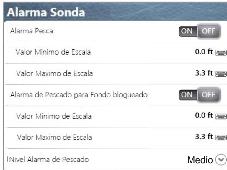
4. Configure la profundidad de inicio en [Valor Minimo de Escala] y la profundidad de fin en [Valor Maximo de Escala].
