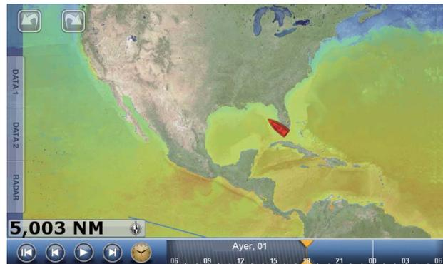
[SST] (temperatura de la superficie marina): Esta capa de datos indica la temperatura de la superficie del mar por medio de un sombreado. Las temperaturas más bajas aparecen en azul oscuro, las más altas, en rojo. En la pantalla puede activar o desactivar la escala SST automática, con solo pulsar [Auto].
