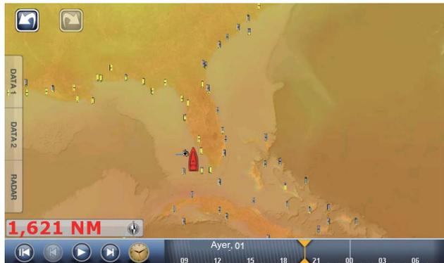
[Corrientes]: La previsión de corrientes muestra la velocidad y dirección de las corrientes de marea por medio de una flecha de color azul. Cuando más oscuro sea el azul, mayor será la velocidad de la corriente (de 0 a 2 kn).
