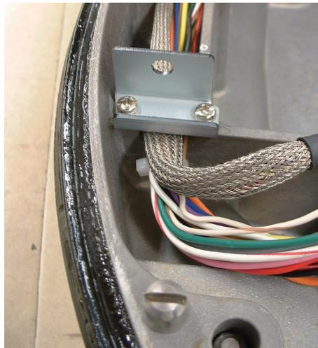
c) Fije el cable de señal mediante la abrazadera como se indica a continuación.
