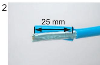
2 Retire la cubierta exterior unos 25 mm. Tenga cuidado de no dañar la cubierta interior y los núcleos.
