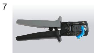
7 Con la herramienta crimpadora especial MPT5-8AS (PANDUIT CORP.), doble el conector modular. Finalmente, compruebe el conector visualmente.
