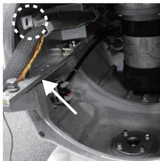
11. Retire la caja de conexiones de la unidad transceptora.
