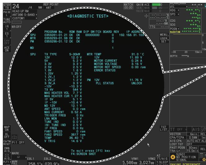
Afficher les résultats du test d'antenne.
