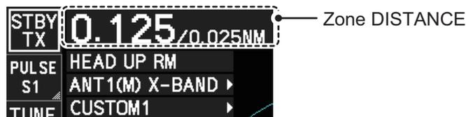
Dans l'exemple ci-dessus, l'échelle de distance est réglée à 0,125 NM et l'intervalle entre les cercles de distance est réglé à 0,025 NM.
