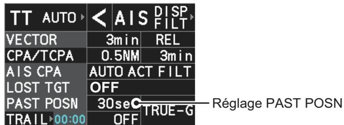
Les positions passées sont affichées en fonction du paramètre sélectionné.
