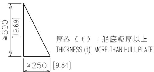
※タンク長 1 m 以上の場合の補強板 (7)
