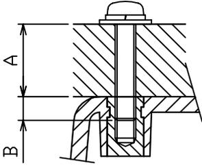
取付ネジ部断面 (尺度 1/1)
