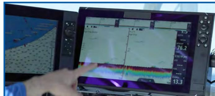
"Cambiamos los transductores y lo conectamos todo pero, desafortunadamente, no parece estar respondiendo. La sonda debería estar en este cuadro aquí y no aparece ahora. Tendremos que volver a puerto y ponernos en contacto con el soporte de su fabricante para averiguar que está pasando".
